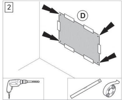
Bohrschablone (D) an der Wand fixieren, Löcher bohren.
