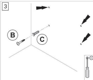
Dübel (C) einsetzen. Schrauben (B) in Dübel platzieren. Schrauben festziehen. Die Schrauben sollten etwa 0,5 cm aus der Wand herausragen.
