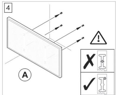
Infrarot-Heizplatte (A) aufhängen.
